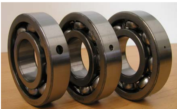
Fig. 2. Rolamentos com furos radiais de Ø8 mm, Ø5 mm e Ø2 mm no anel externo.
